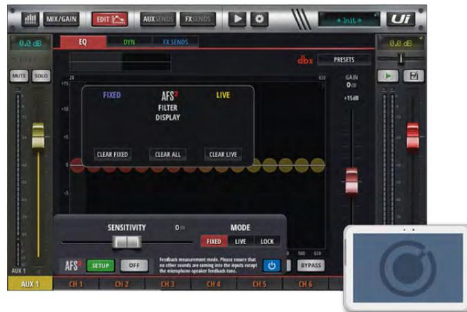
AFS<sup>2</sup> bietet zwei Modi: „**Fixed**“ dient zum „Ausklingseln“ (Rückkopplungserregung) einer Anlage vor der Veranstaltung, um über eine maximale Aussteuerungsreserve zu verfügen. Im **Live**-Modus werden die Filter fortwährend verschoben und bei Bedarf aktiviert.
