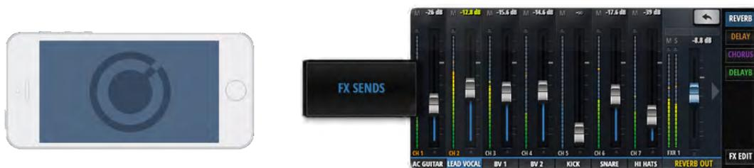
Auf der „MIX“-Seite werden alle Effektrückwege angezeigt. Man kann sie aber auch mit dem [FX RETURNS]-Button in der Schubleiste der Tablet-Software oder über das „JUMP TO“-Menü in der Schubleiste der Smartphone-Software aufrufen.
