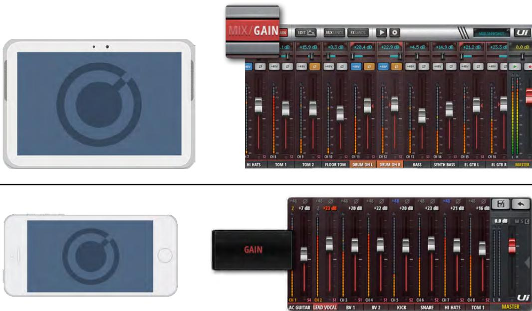
Alle Ui-Mixer erlauben die abgesetzte Einstellung der Eingangspegel sowie der Phantomspeisung. Somit braucht man für diese Aspekte nichts auf dem Ui selbst einzustellen.
