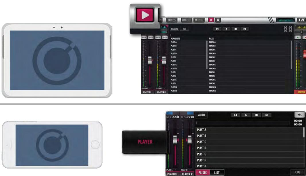
Die Aufnahme- (Ui16) und Wiedergabefunktion ist für beide USB-Ports der Ui-Hardware belegt, die auch durchaus simultan genutzt werden können. Der Ui16 ist frontseitig mit einem PLAY- und REC-Port ausgestattet; der Ui12 bietet nur einen USB PLAY-Port. An der Seite des Geräts befinden sich noch zwei weitere USB-Ports.
