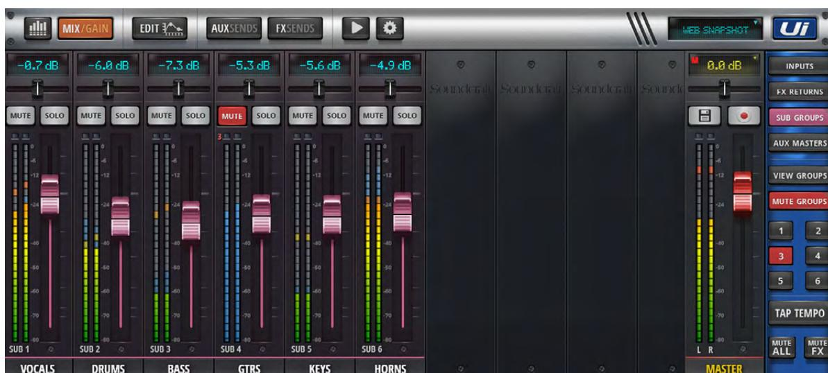
Auch für die Subgruppen-Master stehen „EDIT“-Kanäle zur Verfügung – genau wie für die Eingangskanäle des Ui.
