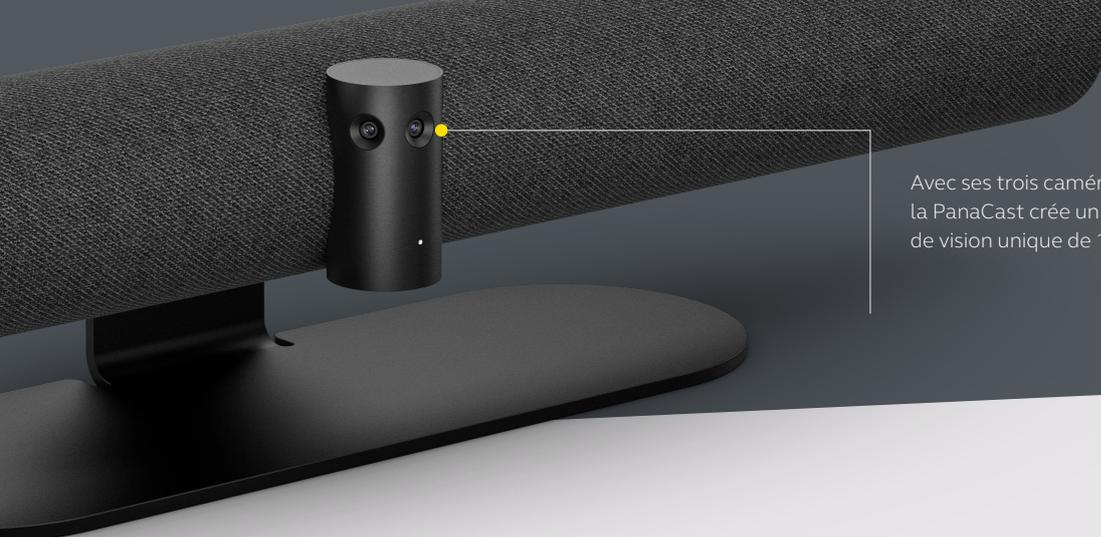
Avec ses trois caméras 13 mégapixels d'une grande précision, la PanaCast crée un flux vidéo en temps réel grâce à un champ de vision unique de 180° couvrant la salle de bout en bout.
