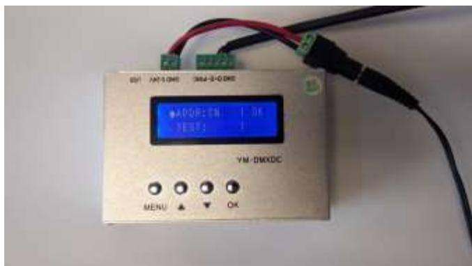
«> ADDR: SN 1 OK» apparaît sur l'appareil avec «TEST: 1» ci-dessous. Avec le bouton de menu, vous pouvez passer du mode adresse au mode test, le> indique le mode dans lequel se trouve l'appareil.
