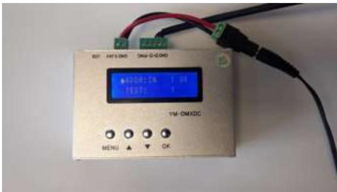
Op het toestel verschijnt ">ADDR: SN 1 OK" met daaronder "TEST: 1". Met de knop menu kan je omschakelen van adresmodus naar testmodus, de > geeft aan in welk modus het toestel staat.
